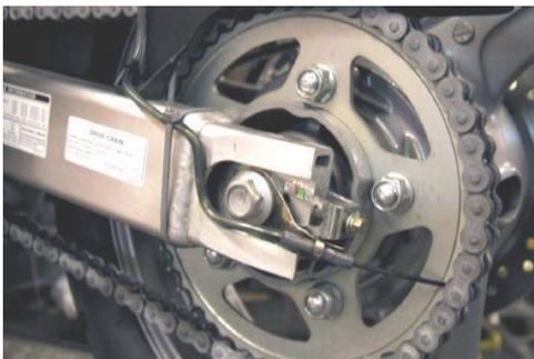
Nach der Montage das [System befüllen und vorpumpen](#), dafür das Einstellrad auf "prime" stellen. Den Motor starten und die Tropfenmenge am Einstellrad reduzieren, bis Sie 1 bis 2 Tropfen pro Minute erhalten. Überprüfen Sie Ihre Kette nach der ersten Fahrt und regeln Sie falls nötig nach.
