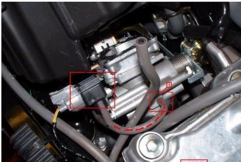
Das RMV kann unter dem Sitz montiert werden. Je vertikaler das RMV montiert wird desto besser. Vermeiden Sie die Nähe des Auspuffs und des Motors. Für weitere Informationen, sehen Sie in die "Easy step Installationen" - [RMV Positionen generell](#).
