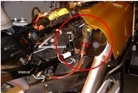
Der Förderschlauch kann am Schwingenarm verlegt werden. Spenderplatte und Schelle (Teile 19 & 20) können an der Radachse befestigt werden. Weitere Informationen in den "Easy step Installationen" - [Förderschlauch Montage generell](#). Die Düse sollte zwischen 6 & 7 Uhr auf das Kettenrad zeigen, die abgeschnittene (kurze) Seite nach außen.
